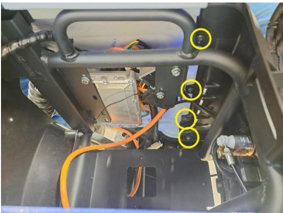
Irrota istuimen vasemmanpuoleisen alasivumuovin kiinnitysruuvit (ristipäämeisseli ph2).
